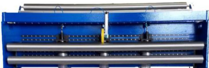
**IMPIANTO** di macro foratura **A INGOMBRO RIDOTTO** per praticare **MACRO FORI** di vari diametri e forme **SU MATERIALE IN MOVIMENTO**, in particolare per il **FILM**
